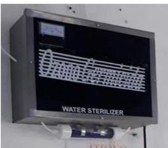
*1 Generador de Ozono de alta potencia (germicida, para matar bacterias, virus). Permite una larga vida útil del agua embotellada en anaquel.*
