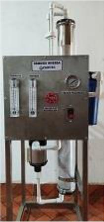
*1 Ósmosis inversa en rack de acero inoxidable, con membrana 4 x 40 con su porta membrana en acero inoxidable. Tablero con indicadores de agua de rechazo y producción*
