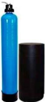
*1 Tanque filtro 9 x 48 con carga de resina catiónica y su válvula del tipo Semi-Automática (suavizador), con su tanque salmuera y sistema especial de succión de sal integrado.*
